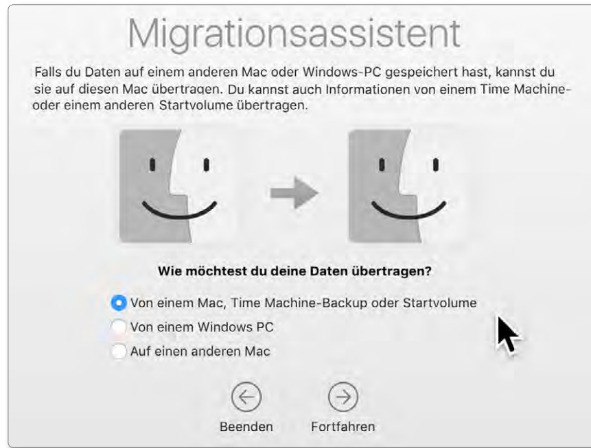
Abb. 8 Der Migrationsassistent bietet mehrere Quellen, von denen man Daten übertragen möchte – in unserem Fall von einem Time-Machine -Backup.
