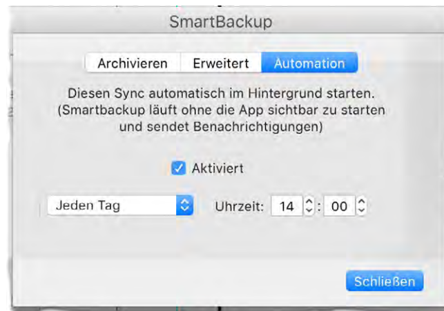
Abb. 5: Hier lässt sich eine zeitgesteuerte Sicherung definieren. Sie läuft ohne Fenster im Hintergrund ab.
