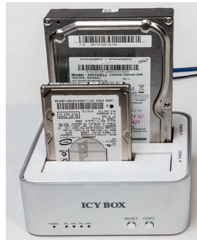
Abb. 2: Eine Harddisk-Docking-Station mit zwei Schächten (beide sowohl für 3,5"- als auch 2,5"-SATA-Laufwerke) erlaubt das autarke Klonen zwischen zwei Harddisk- oder SSD-SATA-Laufwerken. Man kann die beiden Laufwerke aber auch über das Rechner-Interface ansprechen (hier per USB 3.0) und das Sichern oder Klonen mit entsprechender Software vornehmen. Solche Einheiten gibt es von mehreren Firmen.
